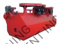
absorbida, y formando un gran número de pequeñas burbujas de aire. Después el flujo constante a través de borde de la placa, estas burbujas se dispersan uniformemente en el tanque, formando burbujas cargadas de mineral. Entonces las burbujas cargadas se elevan hacia la capa de espuma, y forman la espuma producida por las paletas o rascador.
